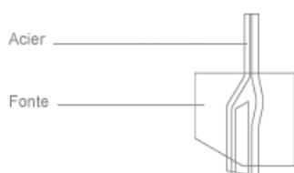
La fonte G-X 300 est un alliage fer-carbone avec une très haute teneur en carbone, d'une dureté plusieurs fois supérieure à celle de l'acier. Les pièces en fonte coulées pour le pare-trottoir sont spécialement fabriquées pour nos lames de chasse-neige.
