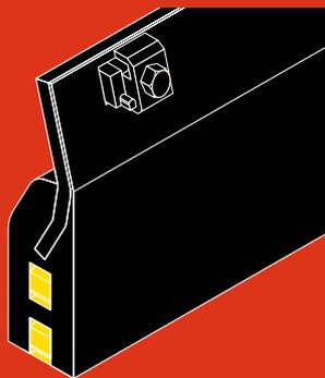
La construction, abritant des éléments corindon agencés de manière flexible, contribue à l'élasticité des lames et empêche que le chasse-neige ne vibre, ne sursaute ou ne rebondisse. Le col de fixation acier empêche que cette lame, de montage facile, ne se plie.
